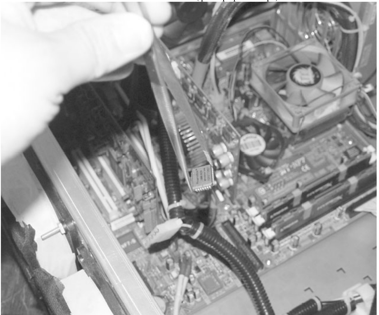
Рис. 2.8. Устанавливаем поврежденный чип BIOS (фотография автора)
