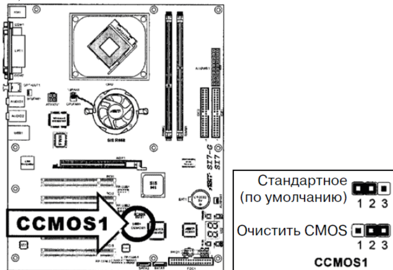
Рис. 2.1. Положение джампера разрядки CMOS, материнская плата ABIT S17 (собственность компании ABIT Computer Corporation; используется с разрешения)
